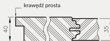
Przekrój poziomy drzwi Scala, Berge
