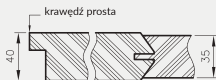
Przekrój poziomy drzwi Elsa
