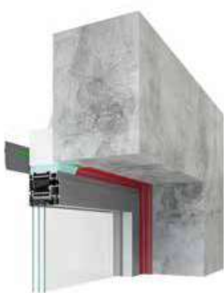
połączenie górne, z taśmą paroszczelną i klejem-uszczelniaczem
