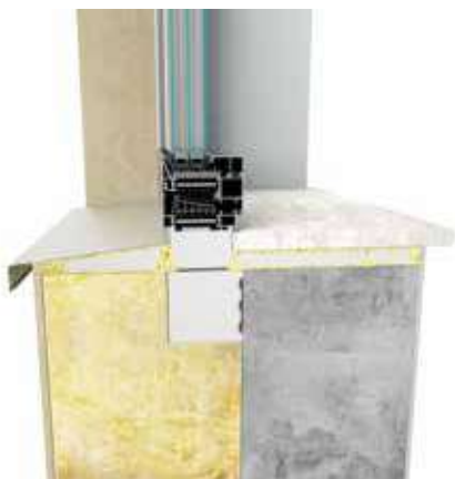
przekrój przez okno zamontowane w warstwie ocieplenia
