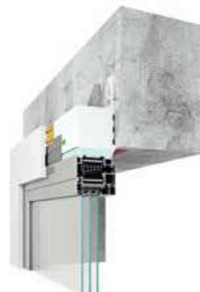
połączenie górne, z zastosowaniem profilu zewnętrznego węgarka
