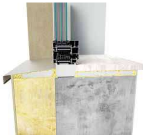
przekrój przez okno zamontowane w licu ściany
